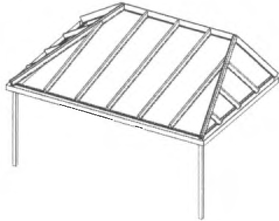
Typ 50 Pulldach, mit seitlicher Abwalmung, beidseitig
