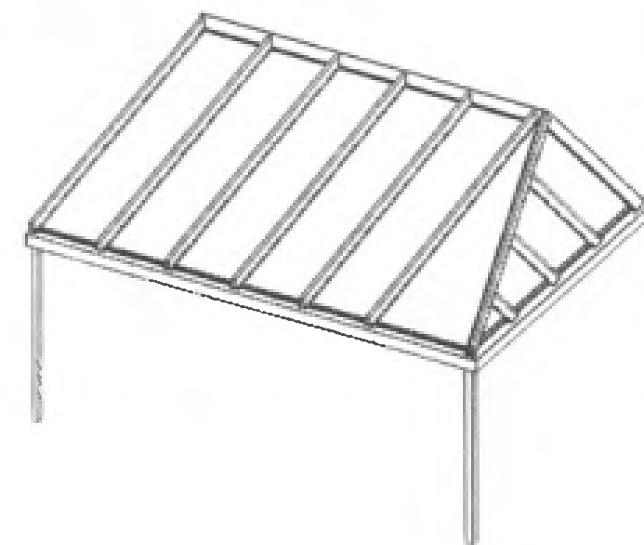
Typ 52 DS Pulldach, mit rechter seitlicher Abwalmung.
