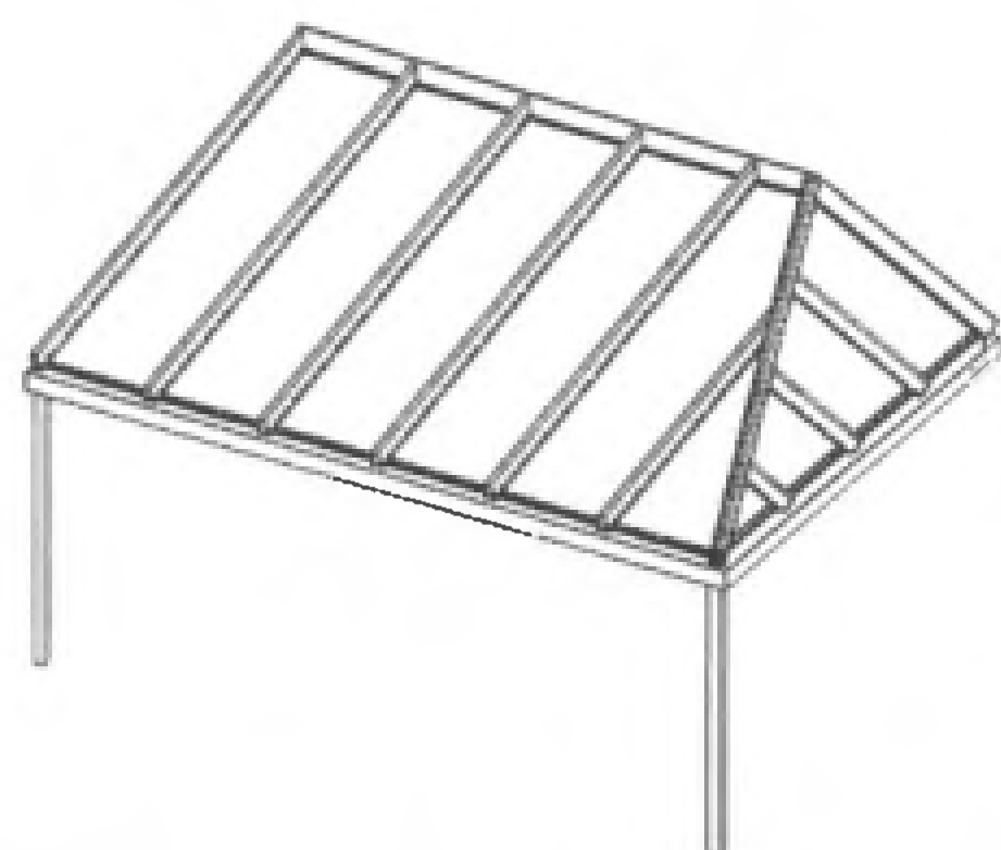
Typ 52 Pulldach, mit rechter seitlicher Abwalmung.
