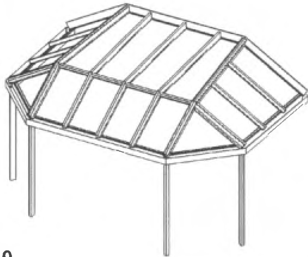
Typ 30 Pulldach mit Solarknick, seitlich abgewalmt mit abgeschrägten Rinnenecken beidseitig. Ausführung der Abwalmung mit Gratsparren.
