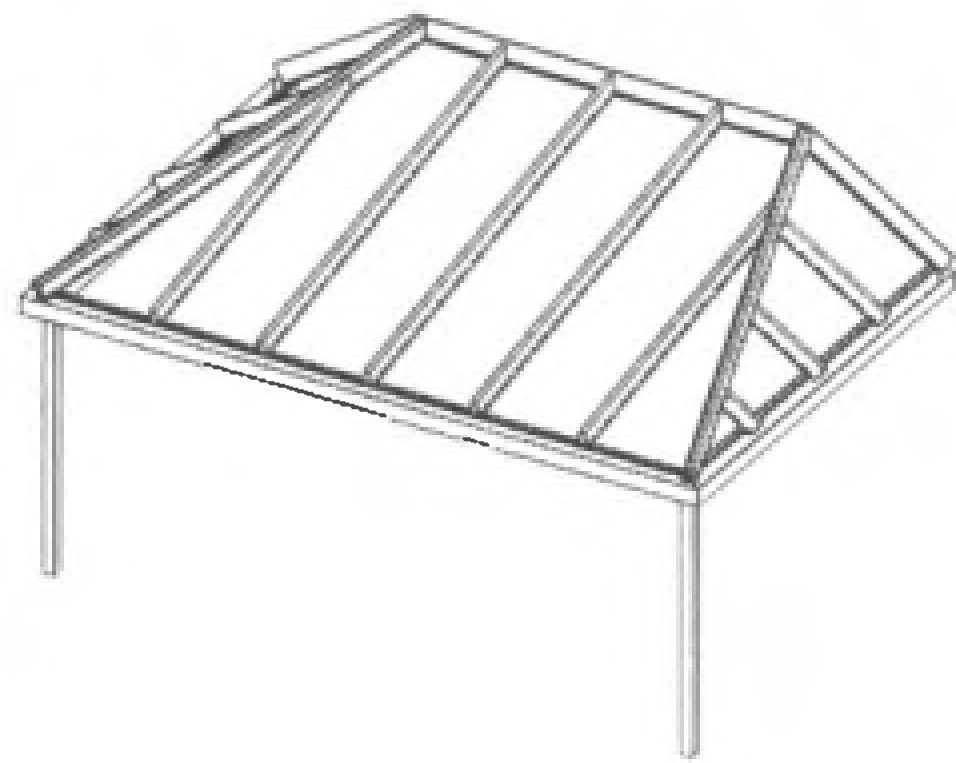
Typ 50 Pulldach, mit seitlicher Abwalmung, beidseitig
