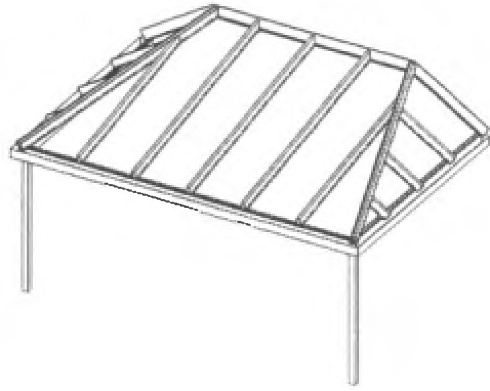
Typ 50 Pulldach, mit seitlicher Abwalmung, beidseitig
