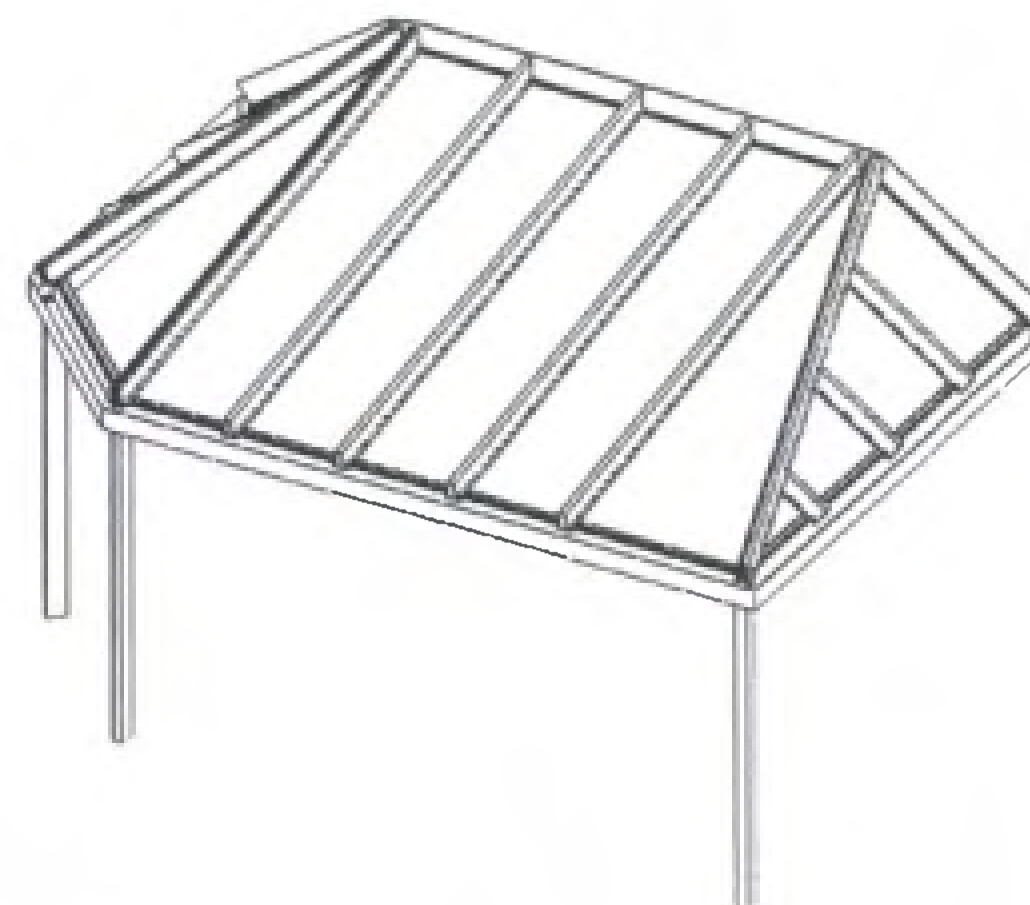
Typ 55 DS Pulldach, mit rechter seitlicher Abwalmung, links mit abgeschrägter Rinnenecke und Abwalmung.
