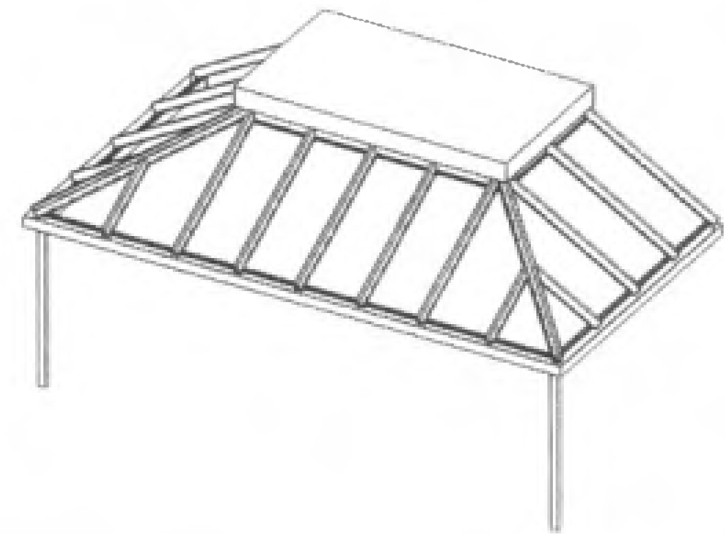
Typ 51 DS Pulldach, mit seitlichen Abwalmungen. Montage links und rechts um den vorhandenen Balkon.
