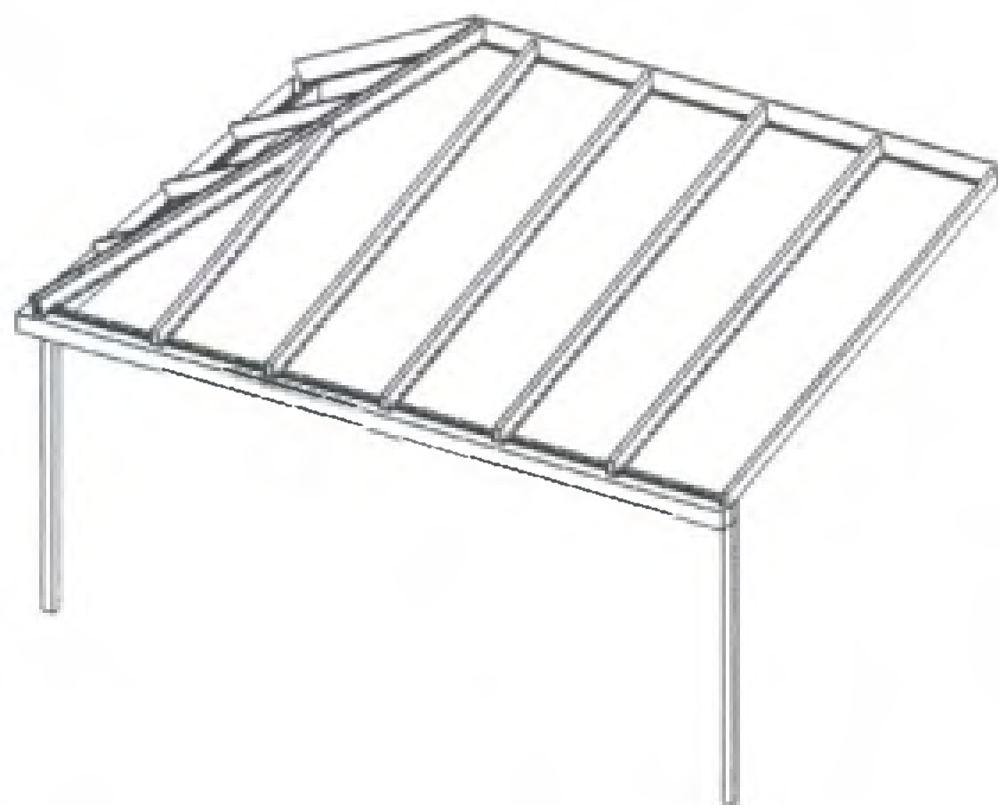
Typ 53 Pulldach, mit linker seitlicher Abwalmung.
