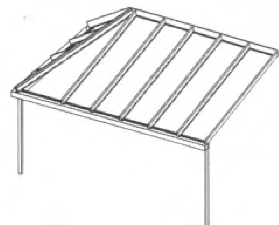
Typ 53 DS Pulldach, mit linker seitlicher Abwalmung.
