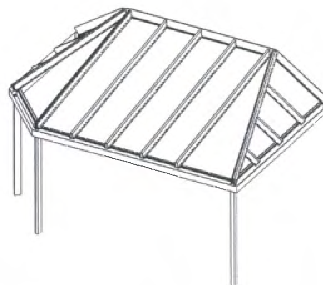
Typ 55 DS Pulldach, mit rechter seitlicher Abwalmung, links mit abgeschrägter Rinnenecke und Abwalmung.
