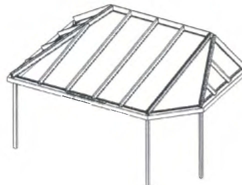
Typ 54 DS Pulldach, mit linker seitlicher Abwalmung, rechts mit abgeschrägter Rinnenecke und Abwalmung.
