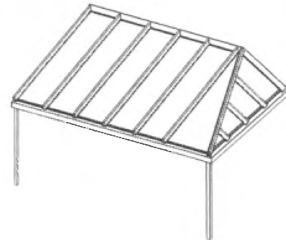
Typ 52 DS Pulldach, mit rechter seitlicher Abwalmung.
